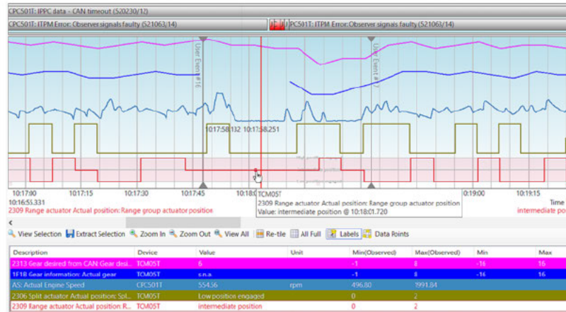
A. TCM5 2313 Desired Gear from CAN D. TCM5 2306 Split Actuator Actual B. TCM5 1F1B Gear Information Actual Position Gear E. TCM5 2309 Range Actuator Actual C. CPC5 AS: Actual Engine Speed Position Fig. 2, Monitored Instruments
