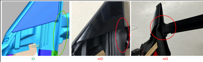
Dichtung innen_Deformation_Welligkeit (2).png
