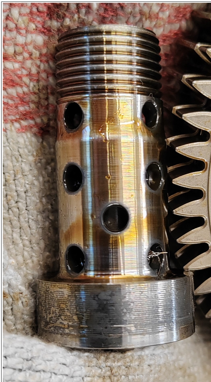
Fehlendes Sieb des Zentralventils.jpg
