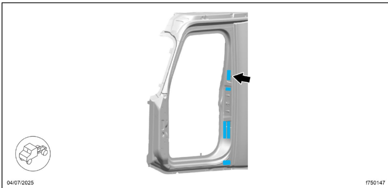
Fig. 1, VECI Label on the Door Panel
