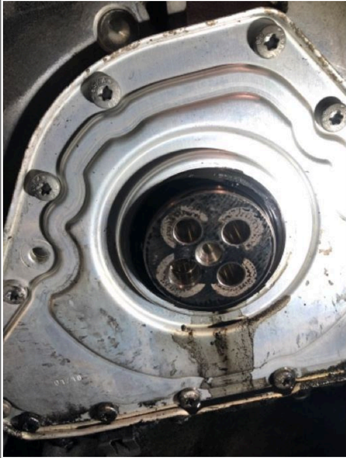
Verschleiß am Kurbelwellenflansch vorn.JPG
