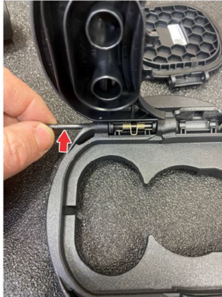
Fig. 3, Pulling Out the Door Hinge Pin
