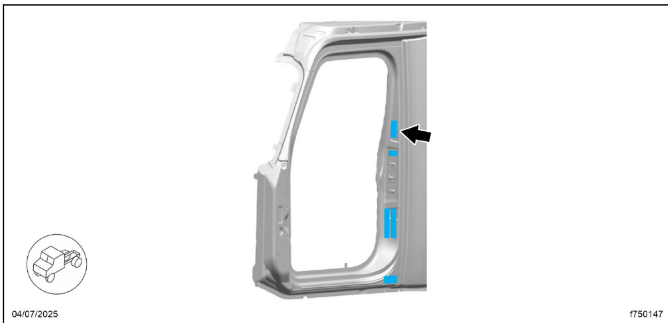
Fig. 1, VECI Label on the Door Panel
