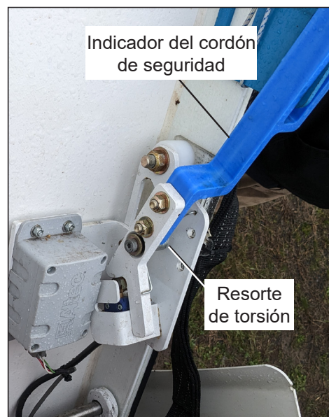
Figura 2 — Mecanismo de acoplamiento del interruptor
