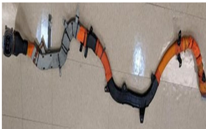
Fig. 1 HV Cable Harness
