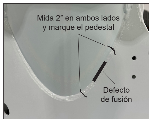
Figure 3 — Ejemplo de marcado del defecto de fusión
