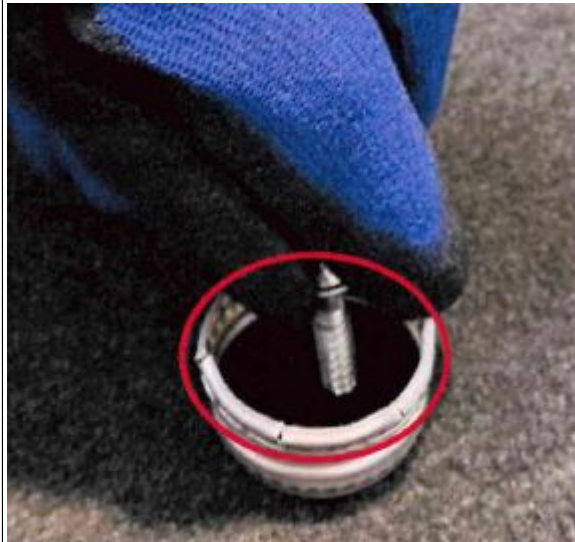
3. Schraube mit Drehmoment 2 Nm wieder einschrauben.JPG
