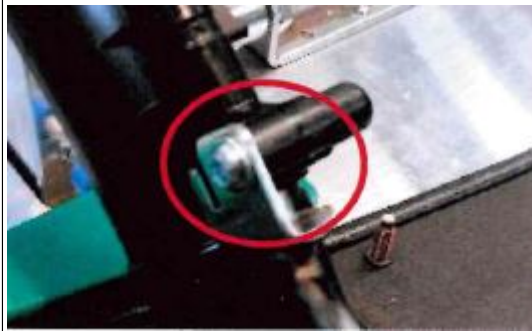
3. Schraube mit Drehmoment 2 Nm wieder einschrauben.JPG
