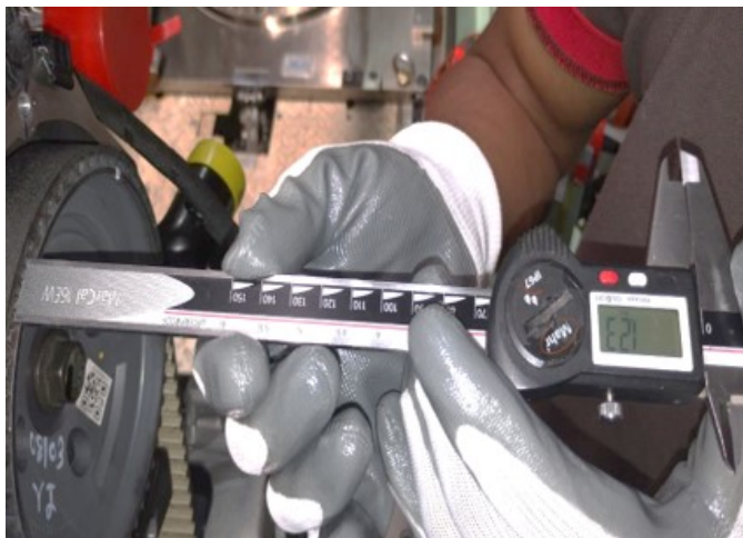
Fig. 6 Vernier Caliper Inspection
