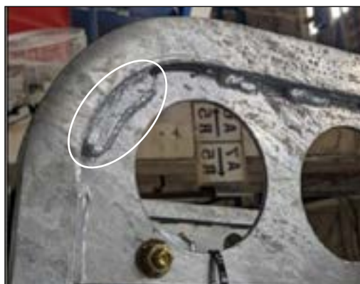
Figure 6 — Soudure ou renfort soudé au milieu de l'angle
