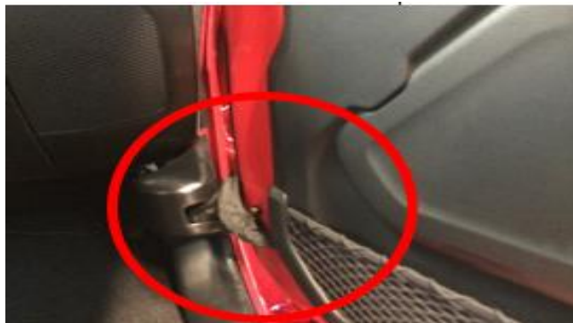
Door Harness Trapped In Door Jamb.
