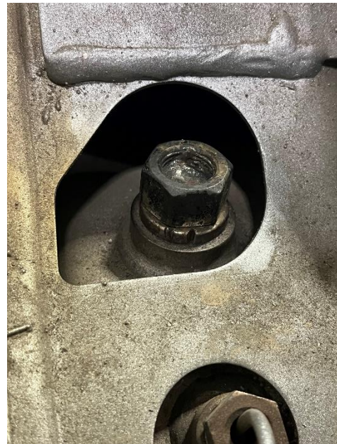
1BOX ATS Soot Sensor Plug - Nut Weld
