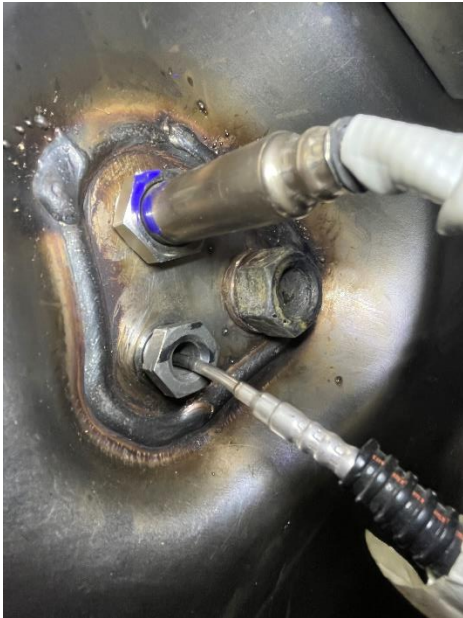
GATS 2.0 ATS Soot Sensor Plug - Nut Weld
