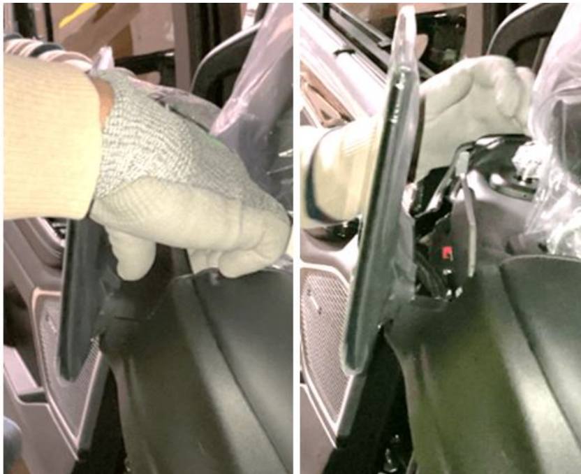
Fig. 3 Remove Upper Panel (Bezel)
