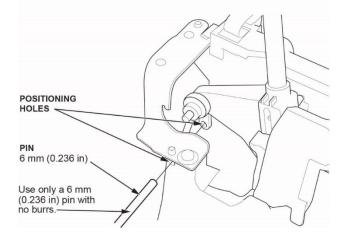
• Remove the shift cable end nut.
