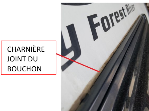
FIGURE 8 JOINT D'ÉTANCHÉITÉ DU CAPUCHON DE LA CHARNIÈRE
