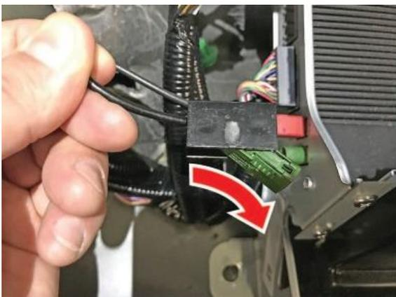
**90 DEGREE FAKRA B PULLER (T/N 07AAC-TJBA100)**
