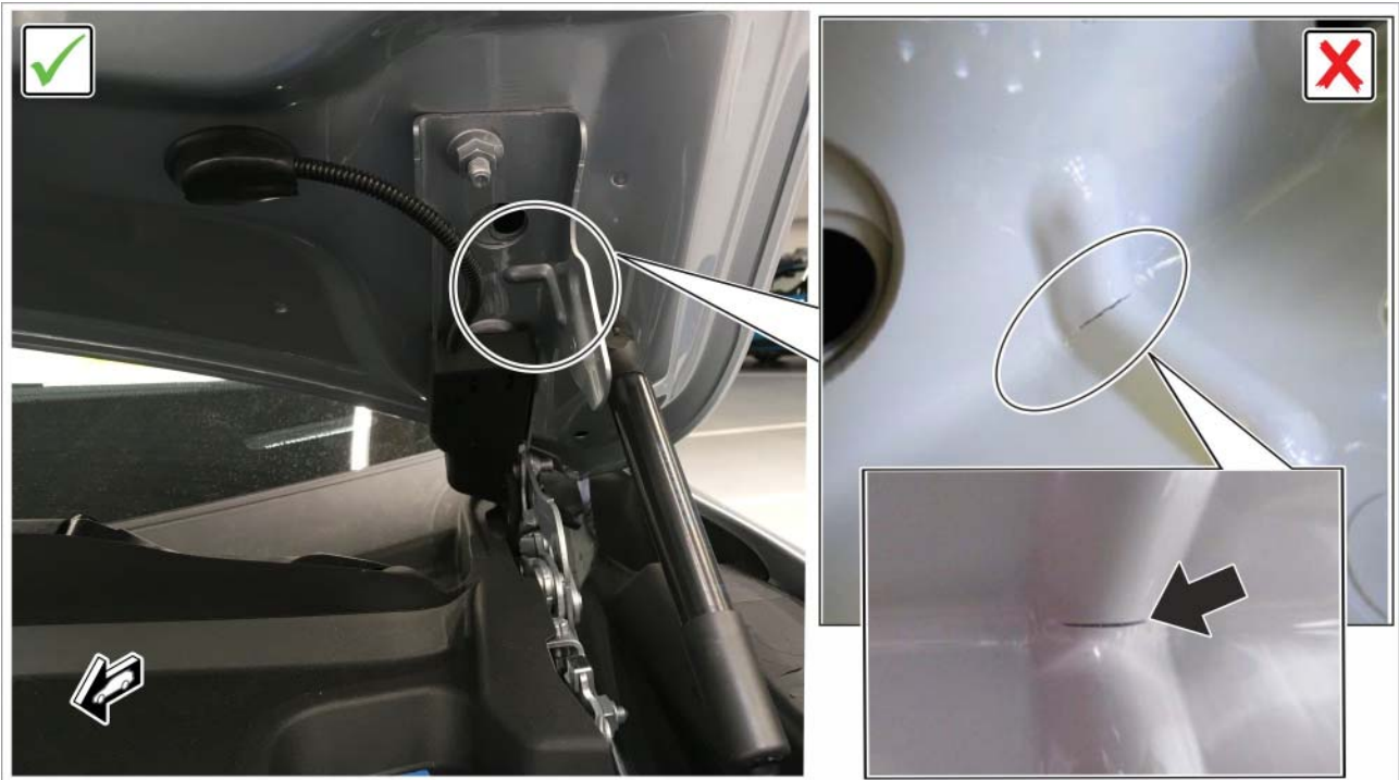
Checking lid hinges
