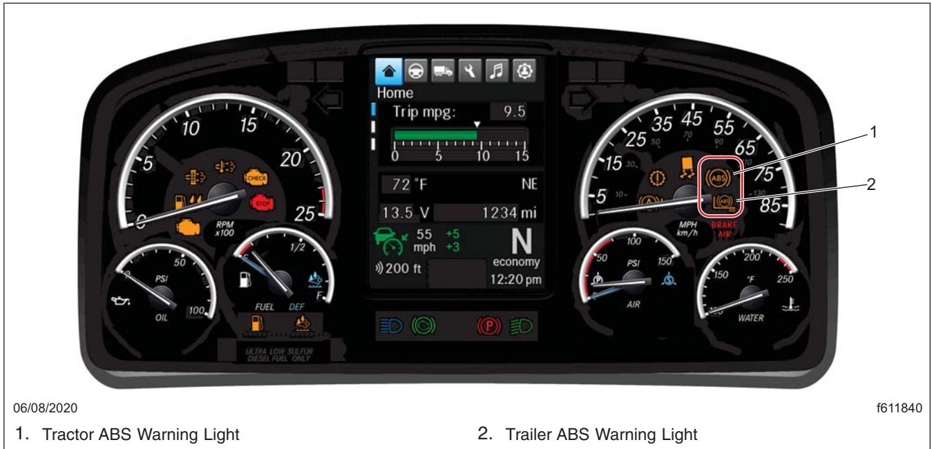
Fig. 1, ABS Telltales on ICUC Instrument Cluster
