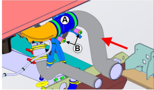
**FIGURE 103: CONNECTION AT THE TURBO OUTLET ELBOW**
