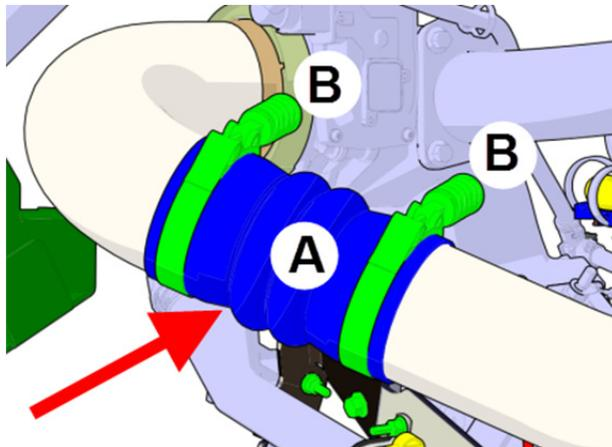
FIGURE 98: CONNECTION AT THE ENGINE INTAKE ELBOW
