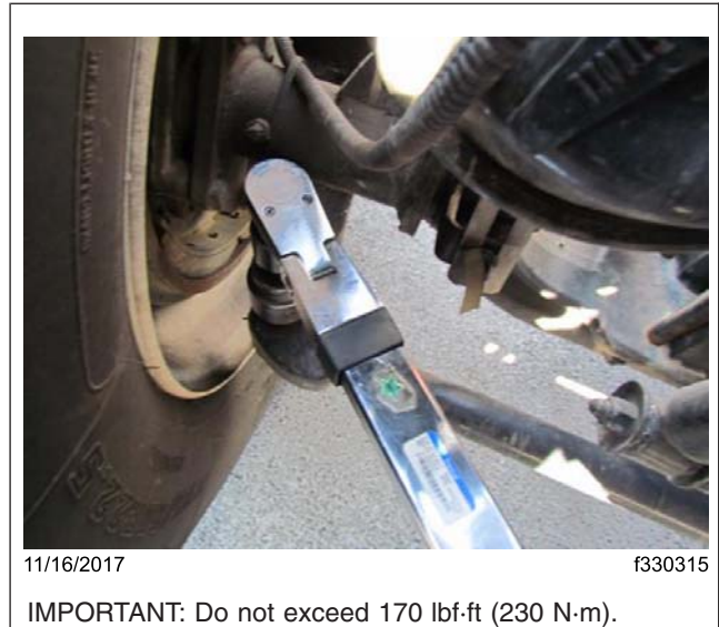
Fig. 4, Check Nut Torque
