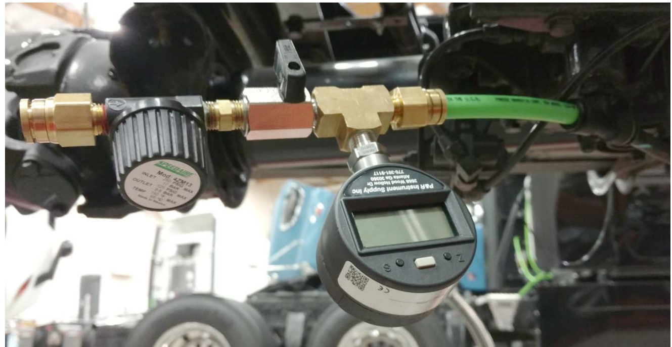
Figura 3, Instalación del medidor usando el orificio de llenado del secador de aire
