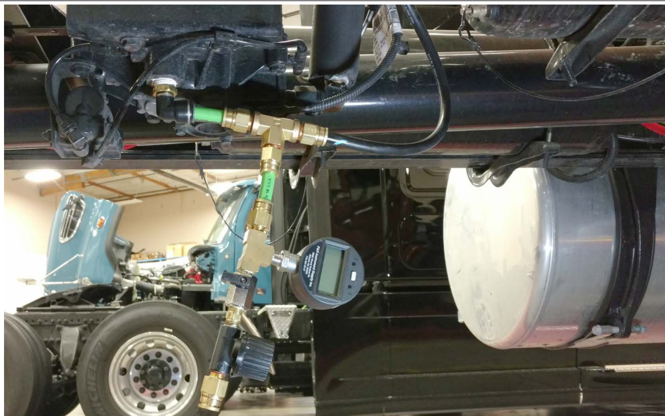
Figura 4, Instalación del medidor usando una línea puente con una conexión en T
