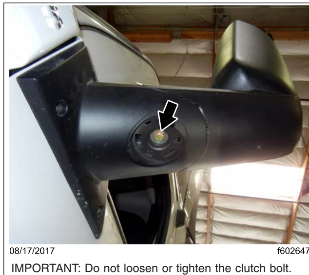
Fig. 1, Mirror-Arm Pivot Clutch Bolt
