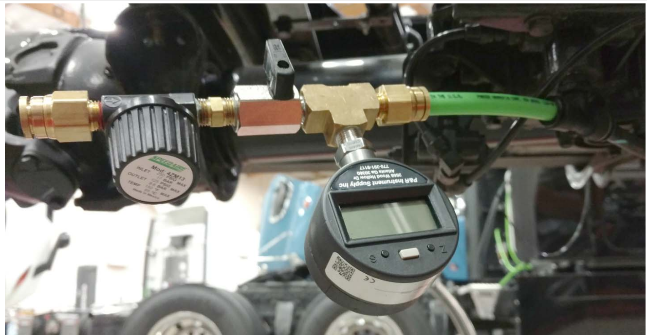
Fig. 3, Installation des manomètres à l'aide de l'orifice de remplissage du dessiccateur d'air
