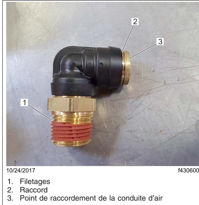
Fig. 1, Raccord de la conduite d'air
