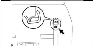
5. REMOVE THE SEAT BACK LOCK CONTROL BEZEL LH & RH
