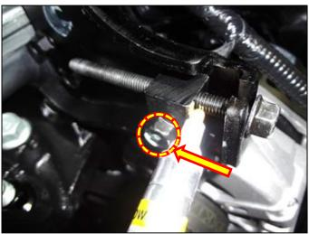
4. Loosen the bottom alternator bolt.
