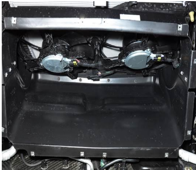
Fig. 2 Fan Air Duct
