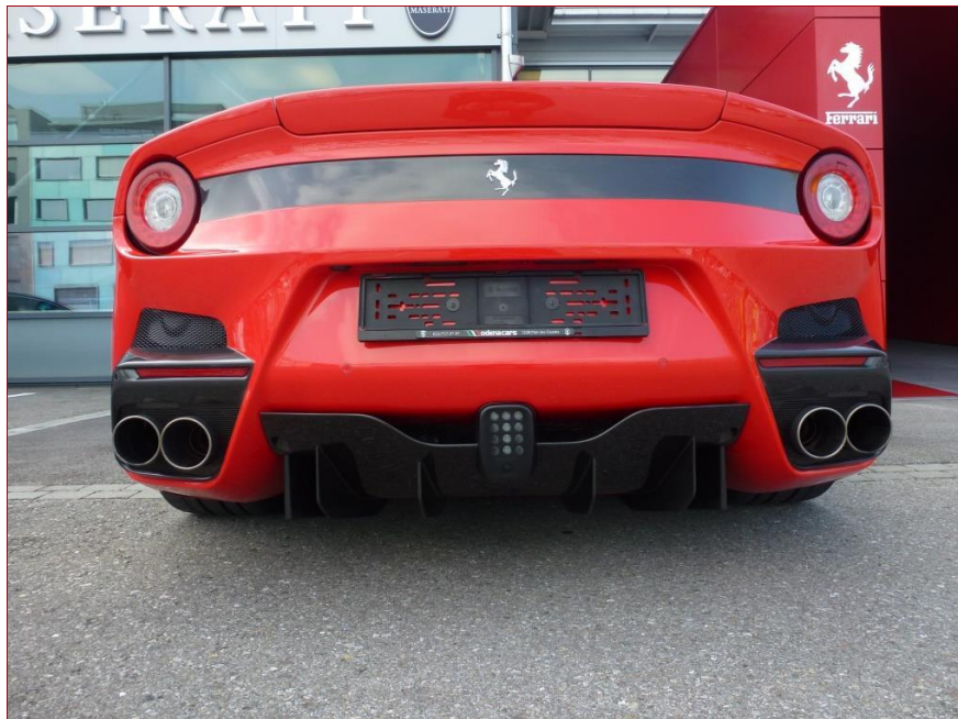
Impianto di scarico Exhaust silencers and outlets
