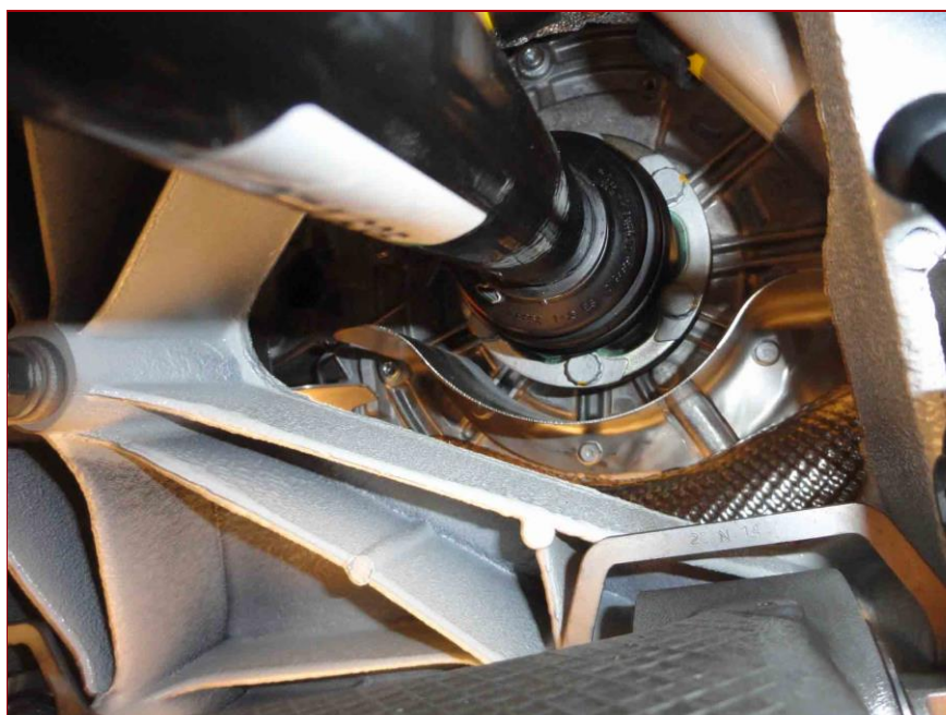
Foto differenziale in vettura (solo nel caso i gruppi siano divisi) Photo of the differential in the car (if the gearbox/differential units are separated)
