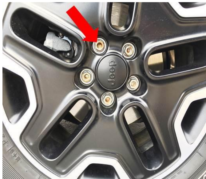
Fig. 2 Lug Stud Rust
