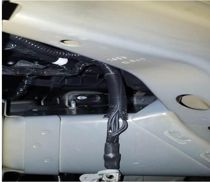
Fig. 9 Fan Out Wires
