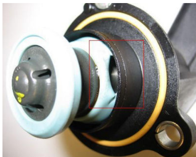
Figure 1. A torn rubber membrane.
