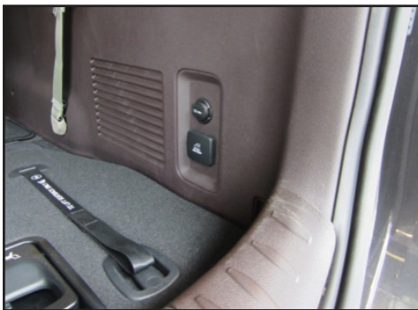
FIG. 1 KIA Sedona A/C Inverter switch and 115 Volt outlets
