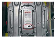
NO BATTERY CODE LABEL ON AN ORIGINAL IMA BATTERY TYPE
