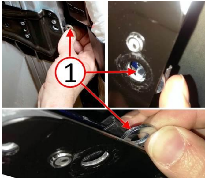
Fig. 3 Shim Sunroof Module
