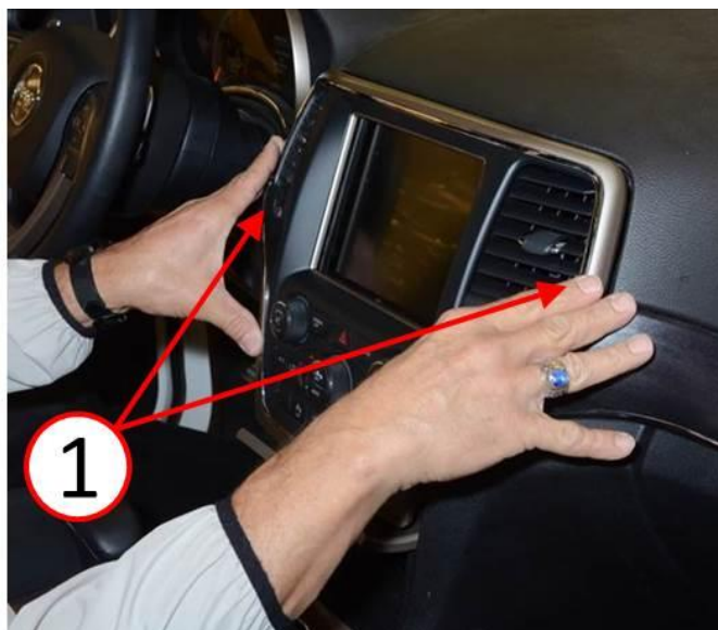
Fig. 14 ICS Bezel Installation
