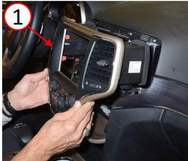
Fig. 13 ICS Bezel Installation
