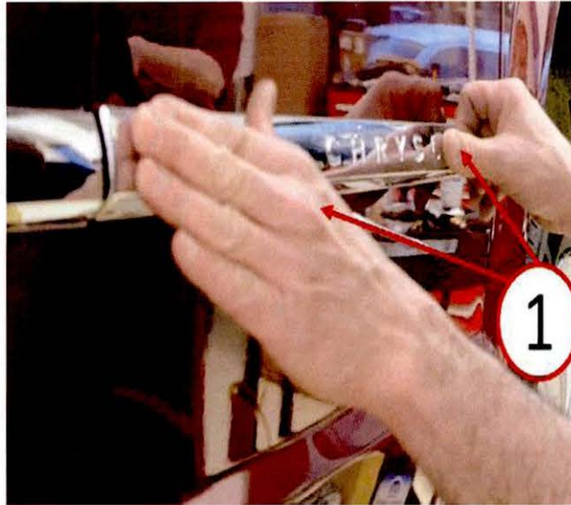
Fig. 5 Installing Right Door Molding
