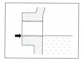
5. Install the filler plug bolt.
