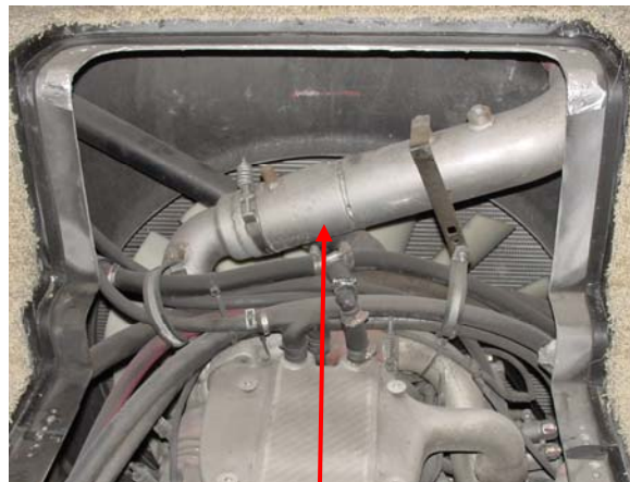
Fig. 4— Remove CAC tube.
