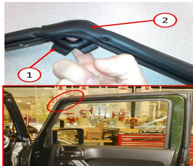
Fig. 11 Door Stuffer Access
