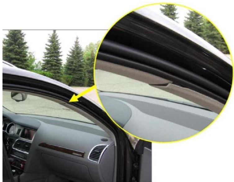
Figure 1. Loose A pillar trim.
