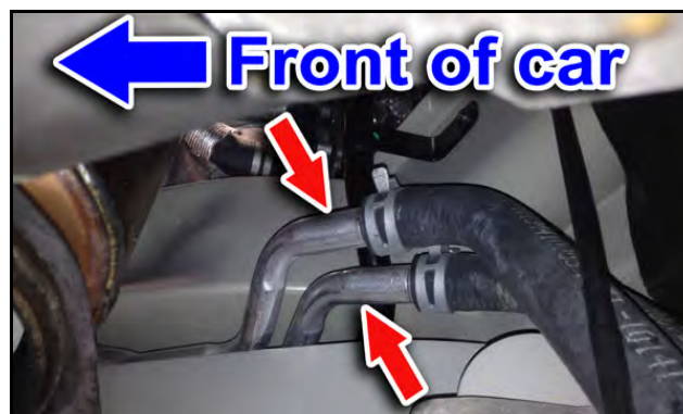
Actual image of coolant pipes.
