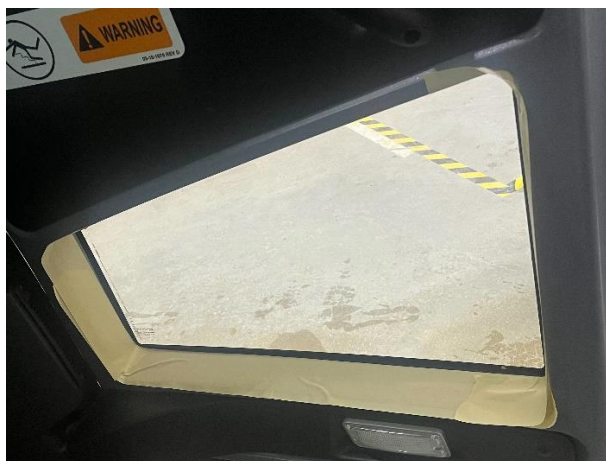
Figure 2 : Panneaux installés sur la vitre inférieure intérieure
