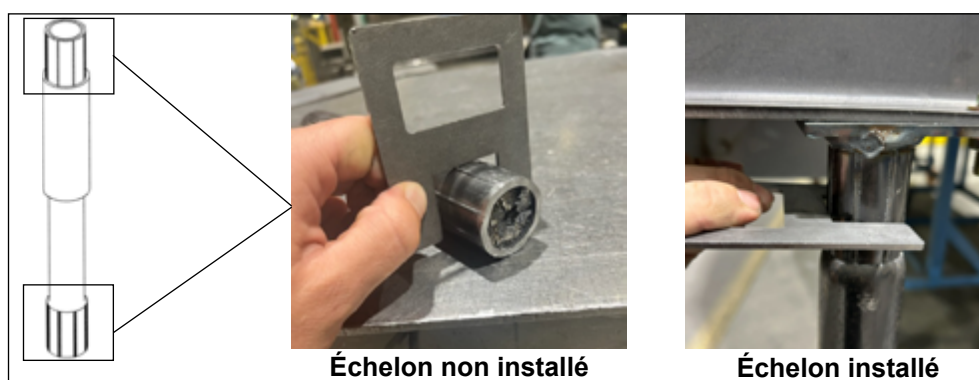
Figure 7 — Mesure du diamètre de sertissage avec un outil de jauge
