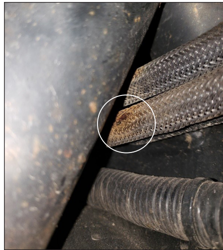
Figure 7 — Exemple de dommages esthétiques sur la canalisation de carburant - Remplacement non requis
