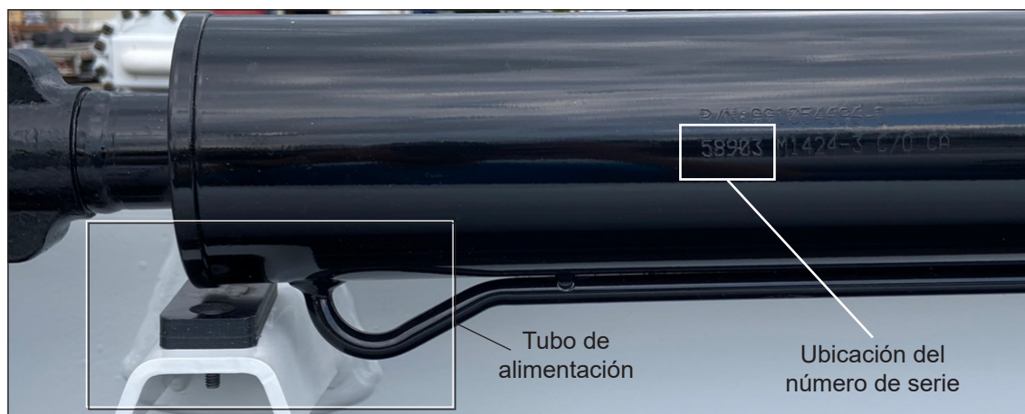
Figura 2 — Inspección del tubo de alimentación y el cilindro
