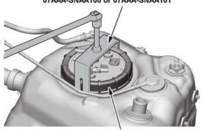
FUEL TANK UNIT LOCKNUT Loosen.
