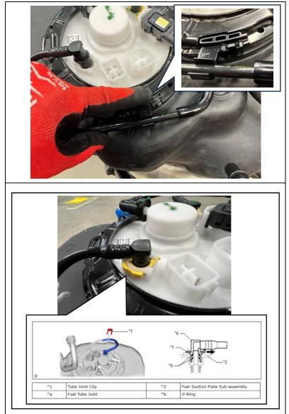
7. INSTALL THE SMALL RETAINER ONTO THE FUEL TANK.
